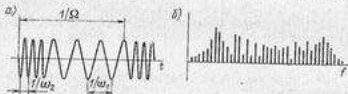
Рис. 2.16. Временная (а) и спектральная (б) характеристики частотно-модулированного сигнала.
