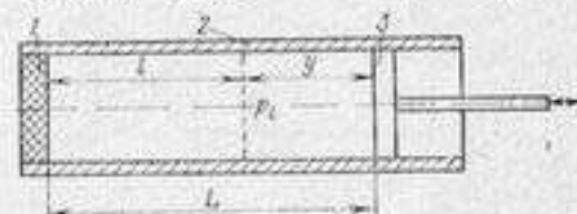
Рис. 6.1. Определение звукового поля в камере отражающего интерферометра. 1 — излучатель; 2 — корпус; 3 — подвижный отражатель.
