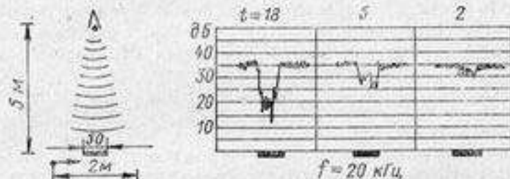
Рис. 2.26. Распределение звукового давления позади пластин. t — толщина.
