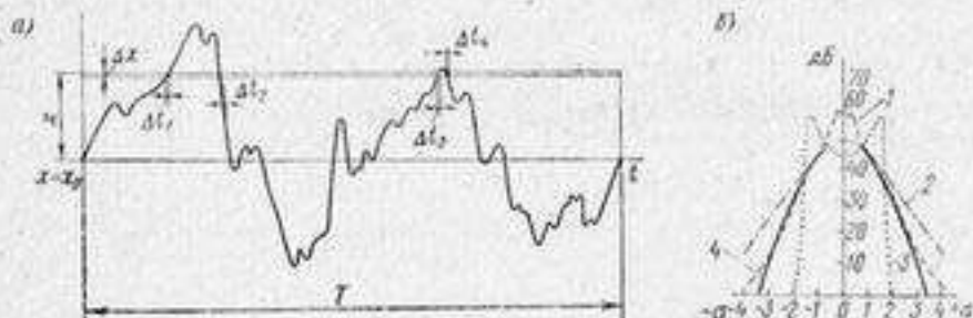
Рис. 5.29. Оценка вероятности по временной характеристике исследуемого сигнала (а) и кривые плотности вероятности для различных акустических процессов (б). 1 — шум в пеще; 2 — речь в аудитории; 3 — воющий тон; 4 — случайный звуковой процесс.
