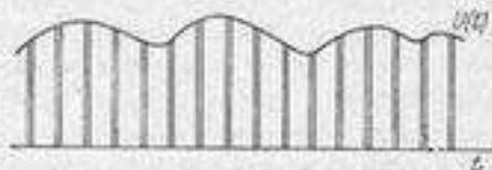
Рис. 4.24. Преобразование непрерывного акустического сигнала в дискретную форму.
