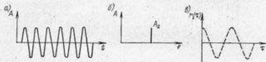
Рис. 2.14. Временная (а), спектральная (б) и корреляционная (в) характеристики гармонического сигнала.
