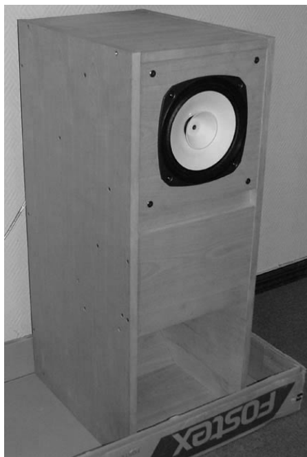
Рис. 3.12. Корпус собран. На боковой стенке видны головки шурупов
