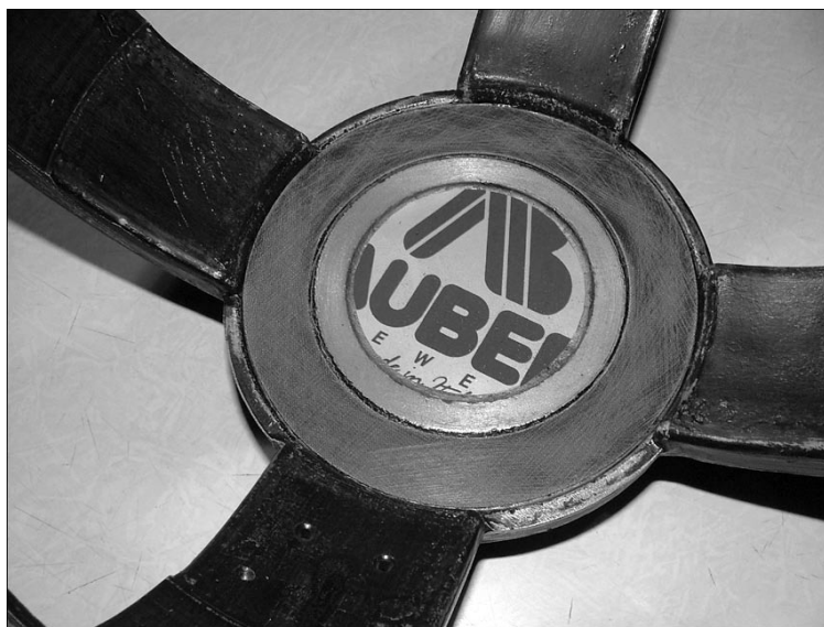
Рис. ПЗ.12. Переходное кольцо между корзиной и диафрагмой наклеено
