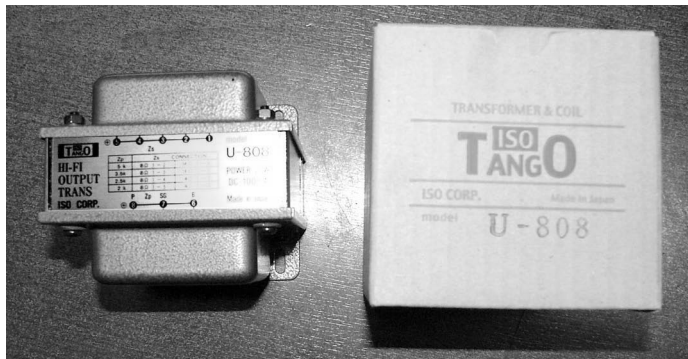
Рис. 2.19. Трансформатор «TANGO U-808»
