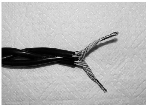
Рис. П2.2 Изготовление акустического кабеля
