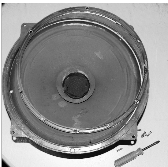
Рис. ПЗ.7. Удаление диффузора
