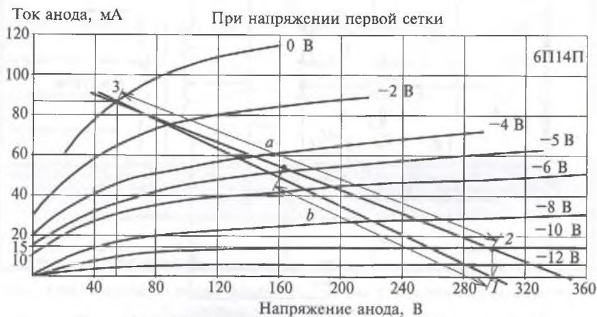
Рис. 4.33. Построение нагрузочной линии для лампы 6П14П
