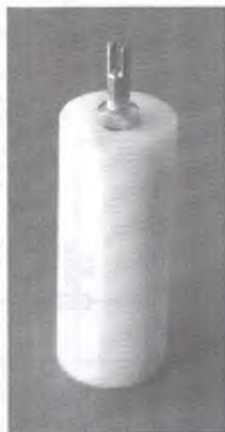
Рис. 5.22. Внешний вид монтажного лепестка
