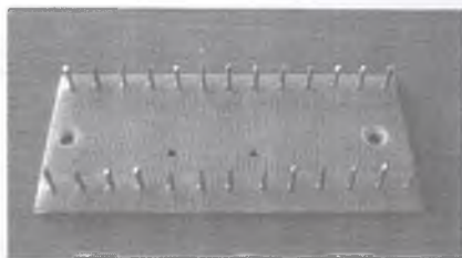
Рис. 5.20. Внешний вид монтажной линейки после высыхания эпоксидного компаунда
